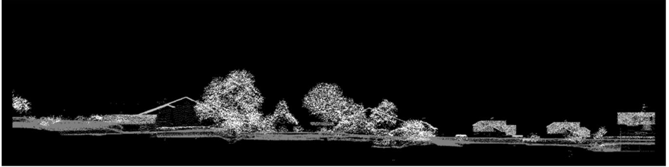
*Exemple d'image LIDAR obtenue dans le cadre du projet INTERREG après le survol d'une zone habitée. Ici on distingue le sol entre les arbres et les toits des habitations (et même les cheminées !).*
